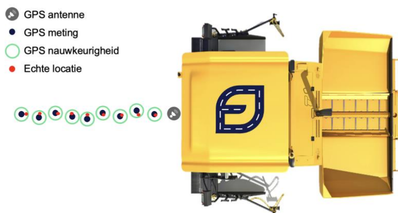
Figuur 39: gps-metingen asfaltspreidmachine
